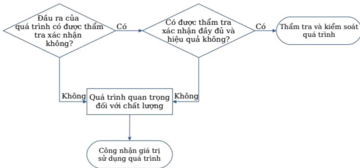
**Hình D.2 - Cây quyết định xác nhận giá trị sử dụng / quá trình quan trọng đối với chất lượng**
